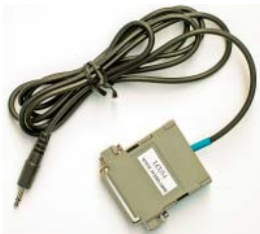
Ein solches Interface sorgt für Datenaustausch zwischen Computer und Transceiver bzw. Empfänger.
